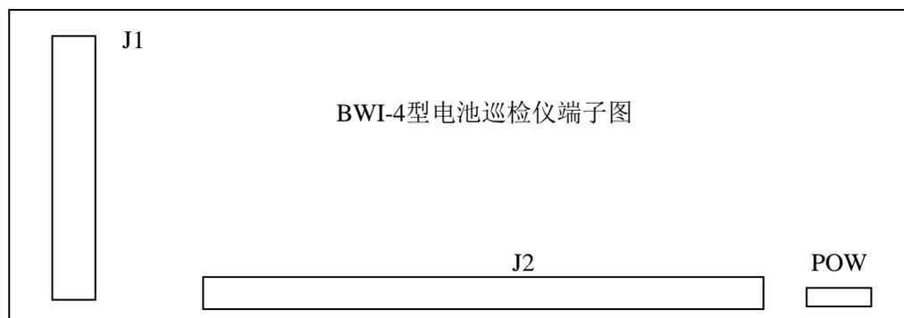
9.1.1 J1端子: 接电池温度,通讯RS485,通讯RS23, 及报警输出。
